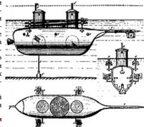
**Подводная лодка конструкции Шильдера. Чертеж 1830-х гг.**
